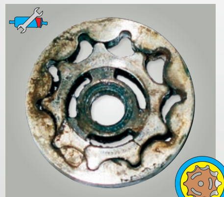
Fig. 19: Impianto di pompaggio bloccato (anello dentato trocoidale) di una pompa ad anello dentato E3T
