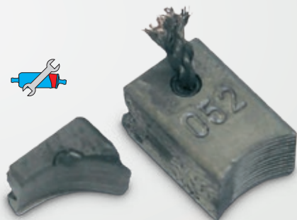
Fig. 62: Contatti striscianti dopo una percorrenza di ca. 15.000 km a sinistra: usura precoce; a destra: condizione normale dopo questa percorrenza
