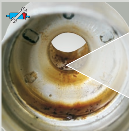
Fig 64: Depositi cristallini a causa di un fluido convogliato non consentito Le cause per depositi del genere in alcuni casi possono essere individuate solo effettuando analisi chimiche dispendiose.
