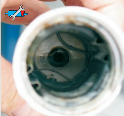
Fig. 44: Acqua in una pompa di alimentazione carburante
