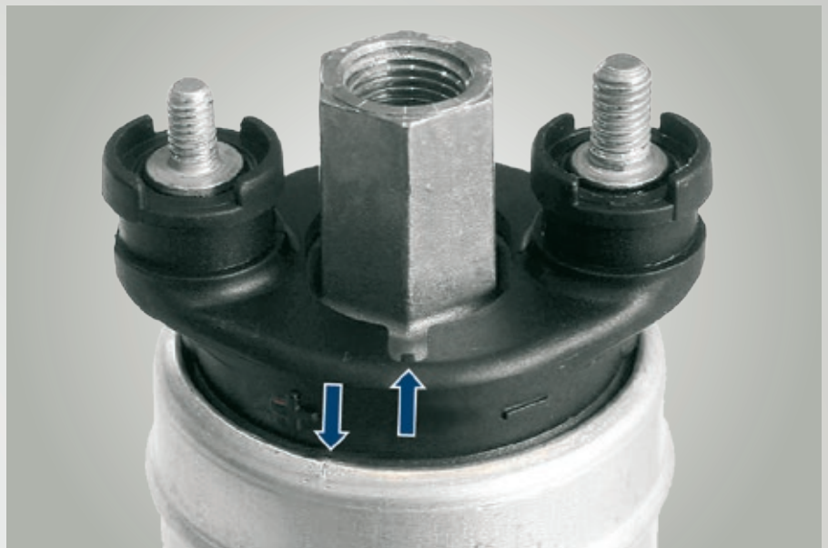
Fig. 69: Coperchio pompa spostato
