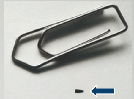
Fig. 27: Corpo estraneo all'origine del danno (confronto dimensionale con una graffetta)
