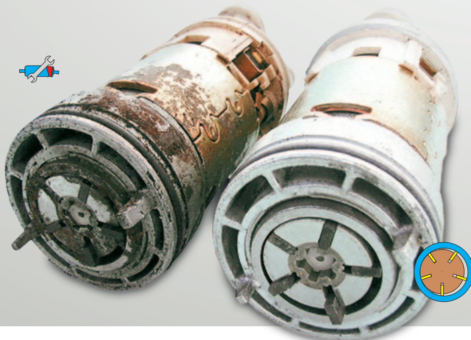
Fig. 36: Danno da acqua su una pompa a palette
