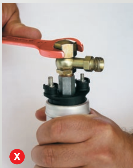
Fig. 70: Montaggio non corretto: serraggio senza bloccaggio
