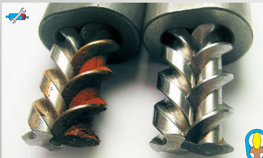
Fig. 54: Pompa a vite (a sinistra arrugginita e a destra a nuovo)
