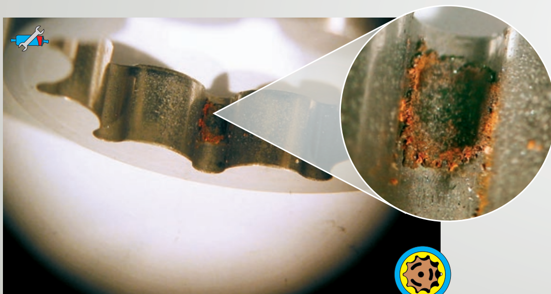
Fig. 47: Anello dentato trocoidale bloccato da particelle di ruggine
