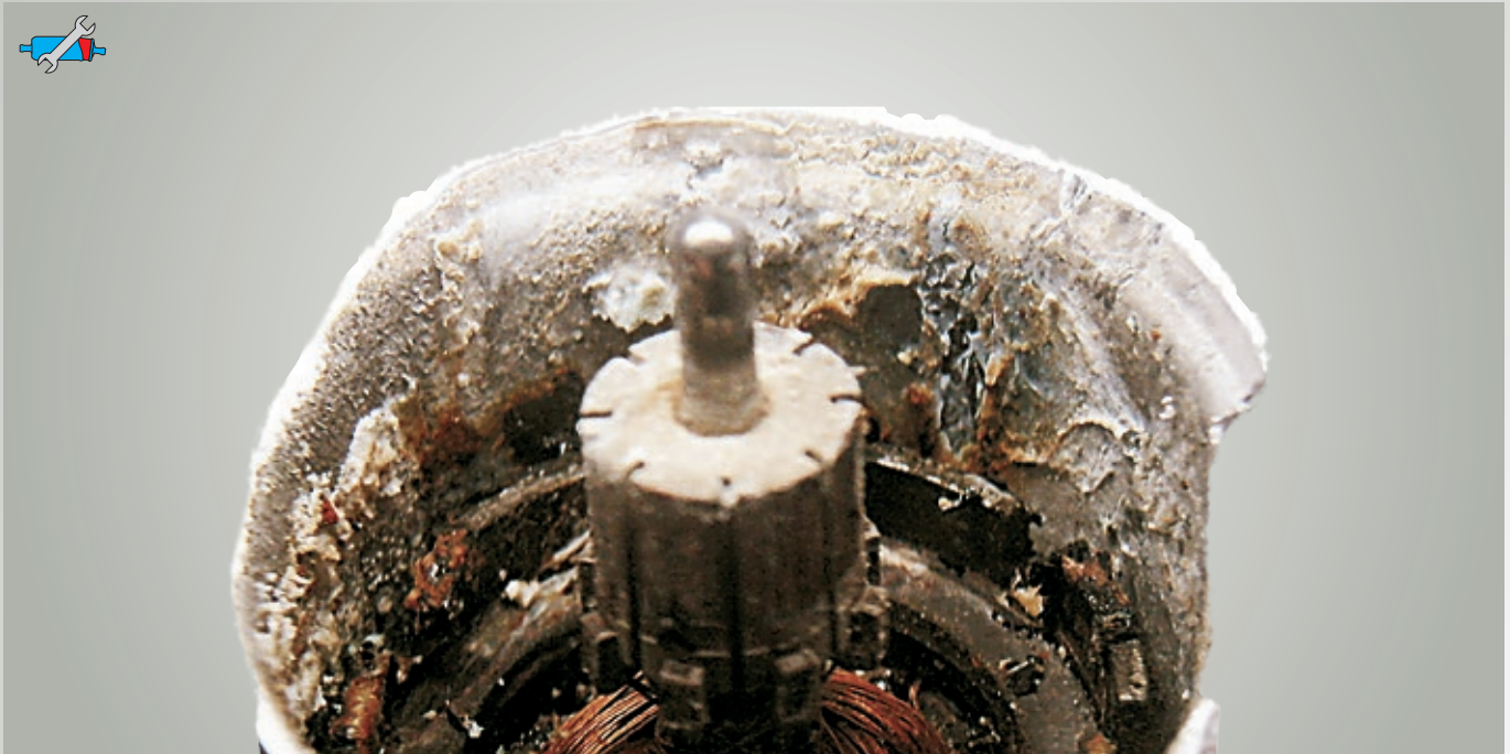
Fig. 16: Pompa elettrica di alimentazione del carburante fortemente corrosa Un'immagine che il meccanico in officina normalmente non vede mai. In molti casi si riesce ad individuare la causa per l'avaria di una pompa di alimentazione carburante solo aprendola, in quanto essa sembra perfettamente integra dall'esterno.
