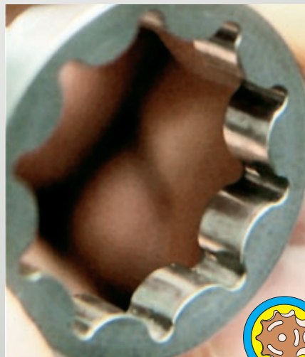
Fig. 51: Anello dentato trocoidale (a sinistra con depositi di calcare e a destra nello stato a nuovo)
