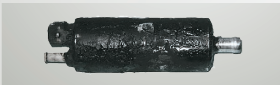
Fig. 65: Pompa inline utilizzata come pompa intank
