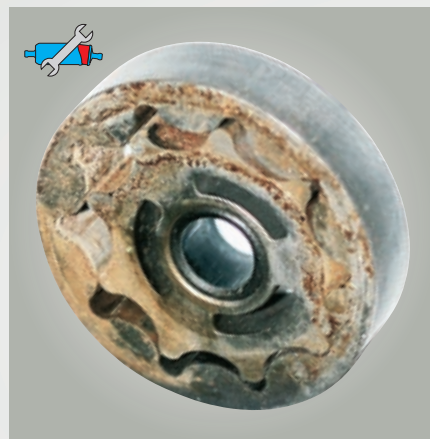
Fig. 53: Per un confronto: un impianto di pompaggio trocoidale arrugginito. Qui è impossibile qualsiasi movimento.
