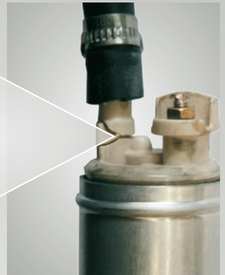
Fig 74: Collegamento tubo flessibile spezzato
