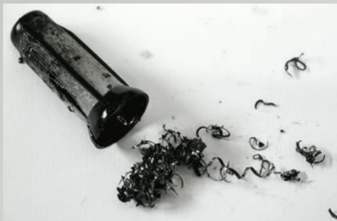
Fig. 29: Trucioli nel filtro a reticella In questo caso si è verificata la penetrazione di trucioli metallici nel serbatoio del carburante durante l'esecuzione di lavori sul sistema di alimentazione del carburante. I trucioli taglienti hanno danneggiato il filtro a reticella. In questo modo, lo sporco può penetrare nella pompa e bloccare l'impianto di pompaggio.
