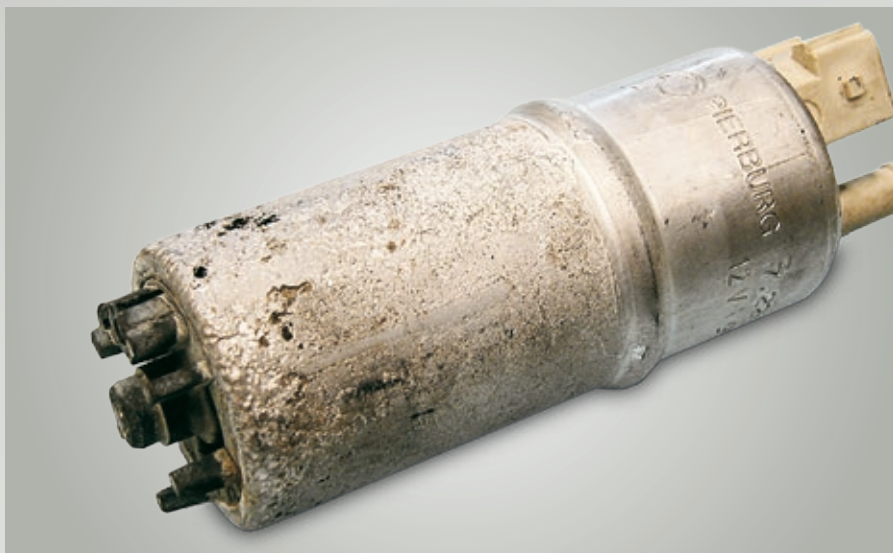
Fig. 72: Corrosione da contatto dovuta all'abbinamento di materiali non compatibili
