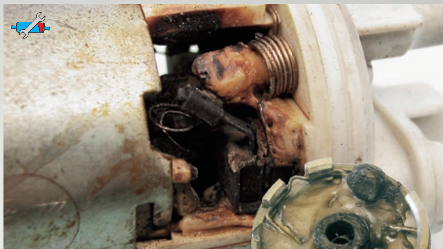
Fig. 20: Danni da fusione in seguito a funzionamento a secco
