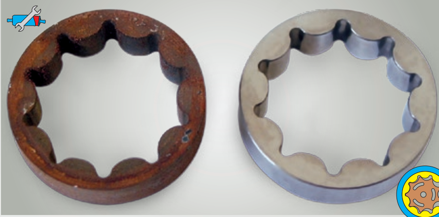
Fig. 48: A sinistra: anello dentato trocoidale fortemente arrugginito; a destra: stato a nuovo
