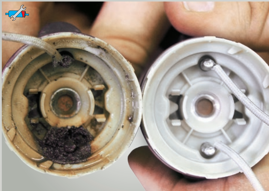
Fig. 46: A sinistra: contatti elettrici corrosi; a destra: stato a nuovo
