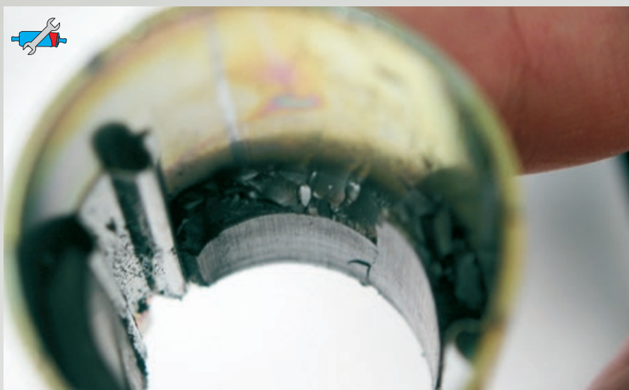
Fig. 80: Magnete permanente (statore) spezzato
