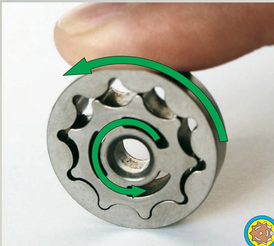
Fig. 52: Un impianto di pompaggio trocoidale deve scorrere senza alcuna difficoltà.
