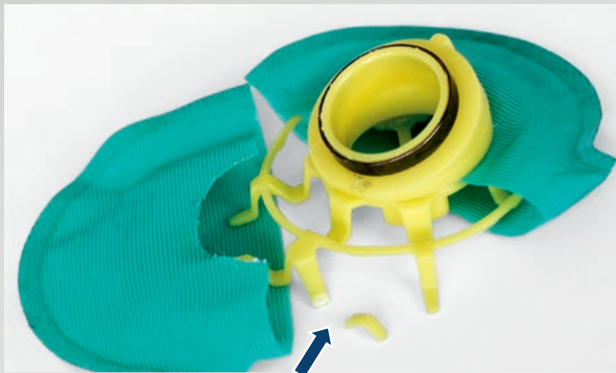
Fig. 76: Nervature di rinforzo spezzate nel filtro di una pompa intank
