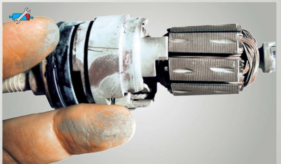
Fig. 56: Deposito dovuto a carburante di scarsa qualità
