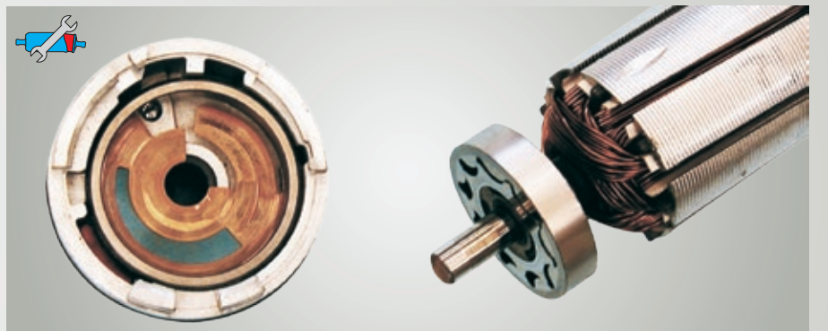
Fig. 38: Per un confronto: pompa ad anello dentato E3T – in buono stato nonostante un chilometraggio elevato
