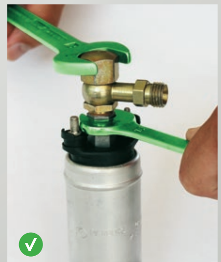
Fig. 71: Montaggio corretto: sull'esagono inferiore della pompa di alimentazione carburante è necessario effettuare il bloccaggio
