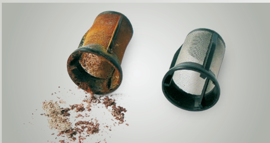
Fig. 41: A sinistra: filtro a reticella otturato dalla ruggine; a destra: filtro a reticella nuovo
