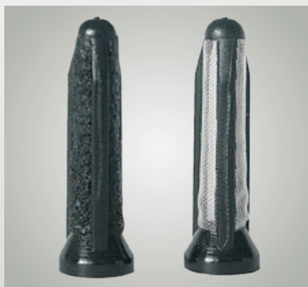
Fig. 22: Filtro a reticella di una pompa a palette E1; F a sinistra otturato – a destra nuovo
