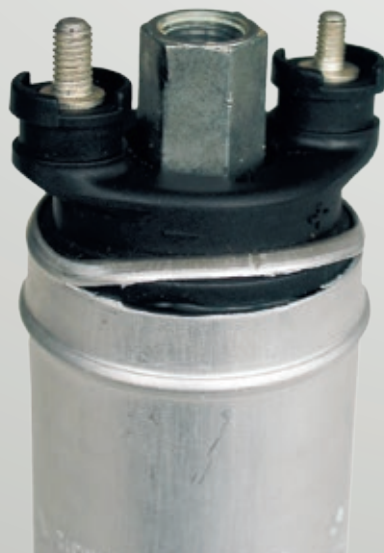
Fig. 1: Danno causato dall'azione di forze esterne Non sempre i danni sono talmente evidenti.
