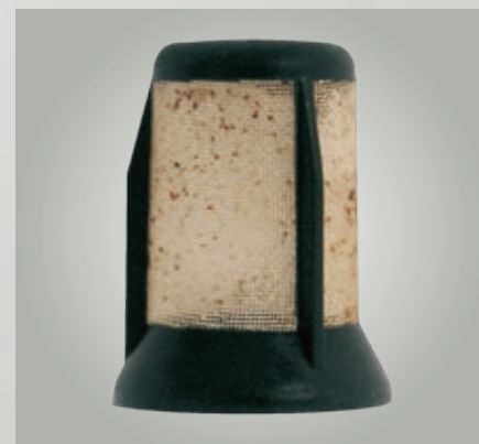
Fig. 23: Filtro a reticella sporco di una pompa ad anello dentato E3T
