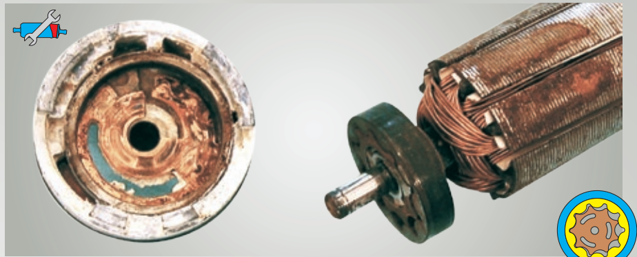
Fig. 37: Pompa ad anello dentato E3T – con depositi di ruggine e calcare
