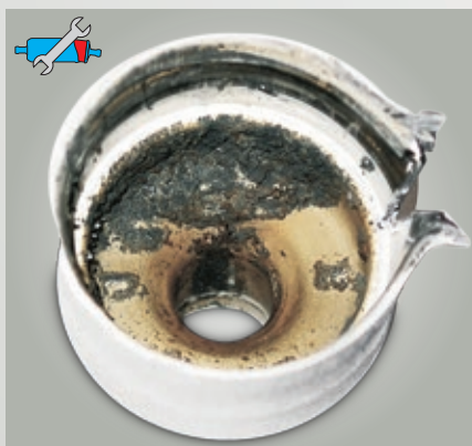
Fig. 18: Vista all'interno della scatola aperta di una pompa ad anello dentato E3T - otturata da depositi di sporco
