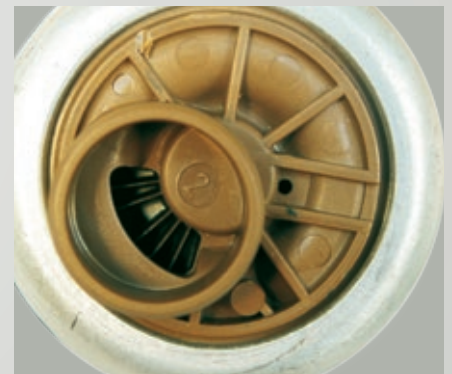
Fig. 35: A confronto: vista nel raccordo di aspirazione di una pompa a canale laterale con girante integra.
