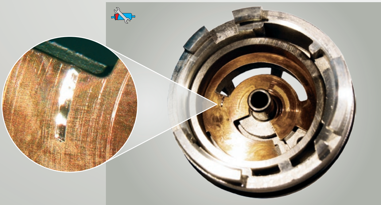
Fig. 25: Graffi causati da un corpo estraneo
