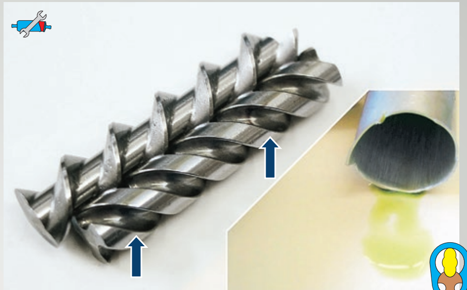
Fig. 55: Incollature dovute ad un fluido convogliato non consentito. La figura mostra l'impianto di pompaggio di una pompa a vite del tipo E3L. Dalla scatola tagliata per l'esecuzione della perizia fuoriescono ancora residui di un fluido verde. Questo carburante ha incollato l'impianto di pompaggio. Il punto in cui le due viti di alimentazione della pompa erano incollate è perfettamente riconoscibile per la presenza di depositi sulla vite di alimentazione (freccia).
